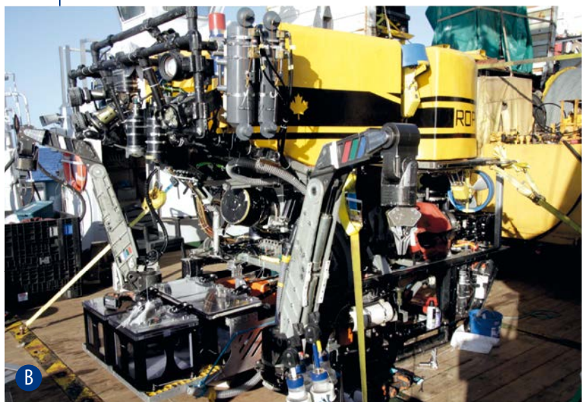
AFBEELDING 9. | Foto's van de Canadese ROPOS diepzee-ROV aan boord van het NIOZ onderzoeksschip Pelagia tijdens een vaartocht voor de Duitse geologische dienst (Bundesanstalt für Geowissenschaften und Rohstoffe). De ROV is ongeveer 2,5 meter hoog. A) Vooraanzicht met links een robotarm, onder vooraan een uitschuifbare lade met vier monsterbakken, meerdere hoge kwaliteit video- en fotocamera's, vele hydraulische en elektrische leidingen en vooral heel veel lampen. B) Zij aanzicht van de ROPOS ROV. De geel/zwarte blokken bovenop zijn drijfschuim. Een ROV is zo ontworpen dat hij altijd drijft als de motoren uit staan en komt dus altijd weer boven als je onderwater een stroomstoring hebt (of de kabel breekt af). C) Het dek van de Pelagia staat vol met apparatuur uitsluitend om met de ROV te kunnen werken. Links op de foto een zeecontainer ingericht als controlecentrum voor de ROV, met op het dak reserve-onderdelen. Rechts een container ingericht als ROV-werkplaats. Tussen de containers staat de lier met de speciale ROV-kabel. Deze kabel is de navelstreng van de ROV. Het ophijzen is eigenlijk bijzaak. De kabel is er vooral om de ROV via de koperen aders van stroom te voorzien, de besturingsignalen door te sturen naar beneden en alle gemeten gegevens en foto- en videosignalen door de glasvezelkabels in deze staalkabel naar het schip te sturen. D) Voorbeeld van meten en bemonstering met een ROV. Rechts zie je de klauw van een van de robotarmen. De klauw houdt een sensor vast voor het meten van de watertemperatuur en het opzuigen van water dat uitgestoten wordt door een black smoker (heetwaterbron met opgeloste metalen) in de Indische Oceaan. Foto: Bundesanstalt für Geowissenschaften und Rohstoffe, BGR.
