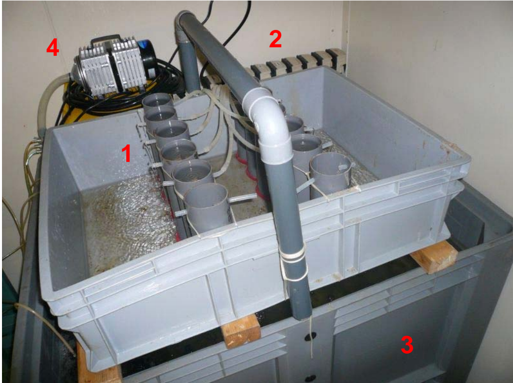
Fig. 7. Filtratieopstelling met (1) 12 cilinders waarvan 10 in gebruik, (2) een slangenpomp, (3) een 500 liter voorraad vat en (4) een luchtpomp.
